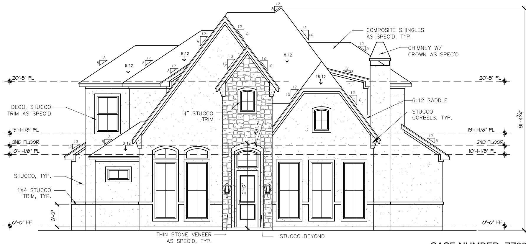
2 FRONT ELEVATION SCALE: 1/8" = 1'-0"
