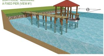
(2): 40-FOOT MAXIMUM; (2): 21-FOOT MAXIMUM; (3): 13 TO 18-FEET MAXIMUM; (3): CAT WALK (UNDERSTRUCTURE TO BE ABOVE THE 437-ELEVATION); (5): CUPOLA; (5): 3 TO 4-FEET MAXIMUM; (2): 435.5-NORMAL POOL ELEVATION; (3): 1.5-FOOT MAXIMUM OVERHANG; (2): 2:1 ROOF PITCH (HIP ROOF ONLY)
